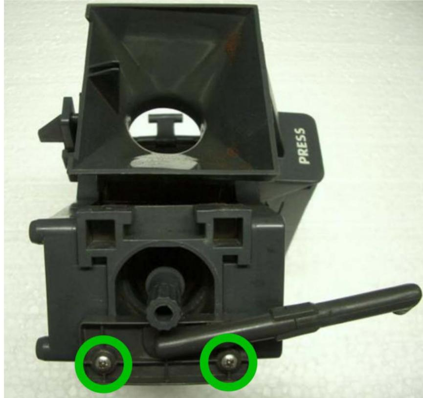
Bringen Sie den Auslauf wieder an und schrauben Sie die in der Abbildung markierten Schrauben wieder ein.
