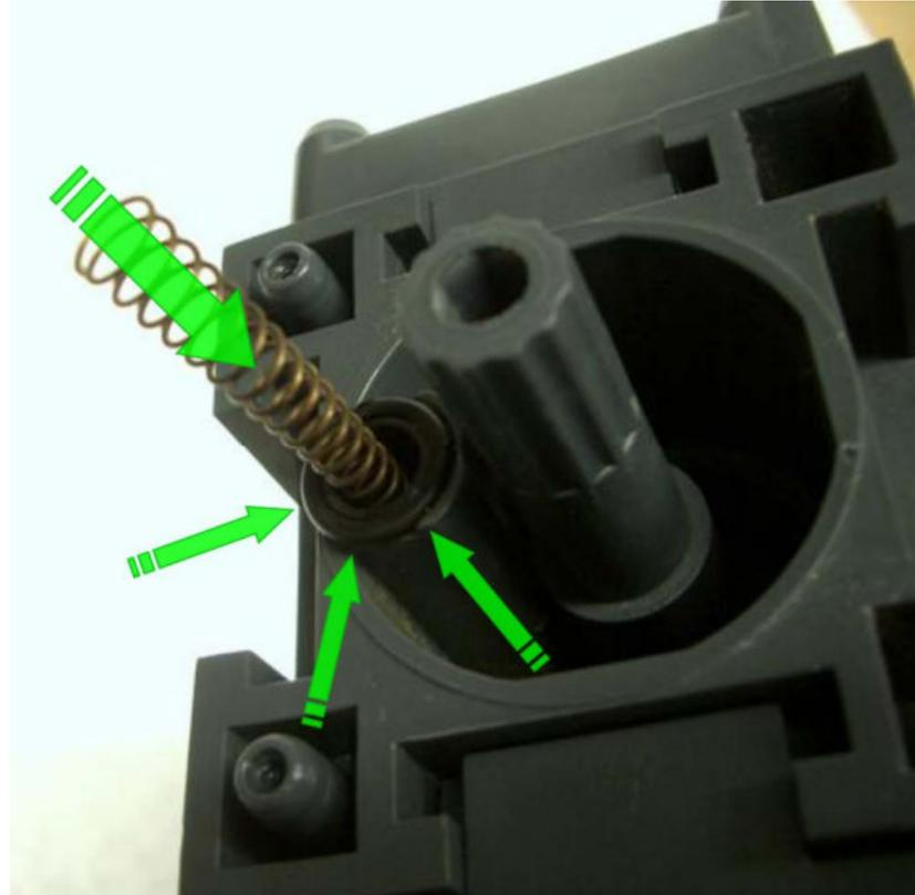
Stecken Sie die Feder (Cremaventil) wieder ins Steigrohr. Achtung, die Feder ist konisch, d.h. sie wird nach unten immer enger. Legen Sie danach den O-Ring wieder in die vorgesehene Aussparung.
