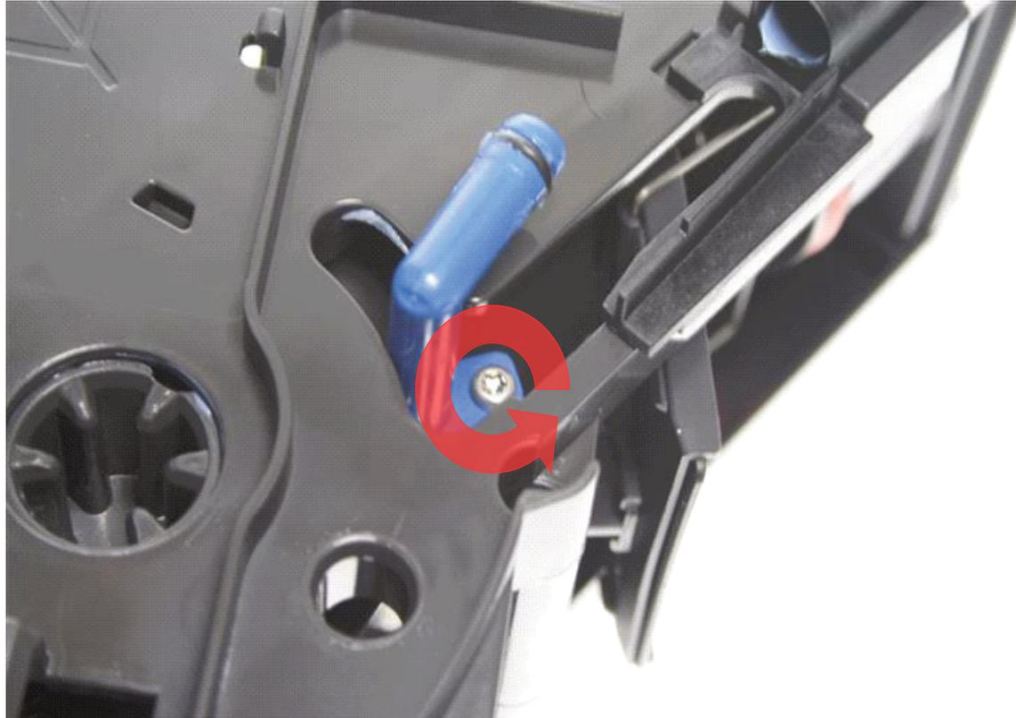
Entfernen Sie jetzt die obere Schraube des Brühkammerzulaufs.
