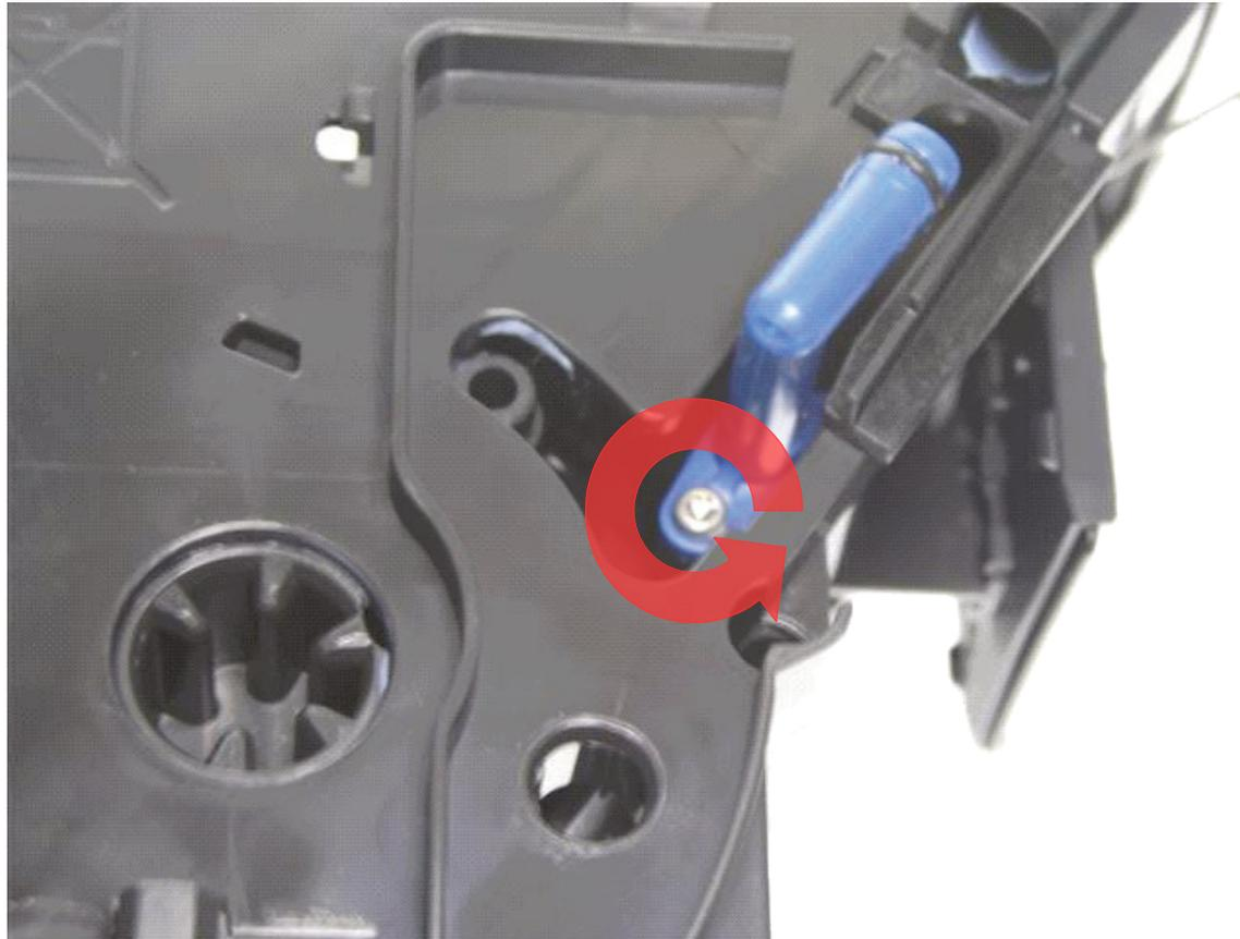
Den Brühkolben nun so weit schieben, dass die untere Schraube sichtbar wird. Diese lösen, nun kann der Brühkammerzulauf entfernt werden.
