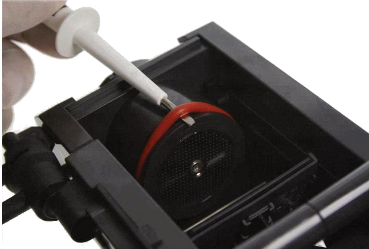
Im nächsten Schritt ziehen Sie den O-Ring des Brühkolben ab.
