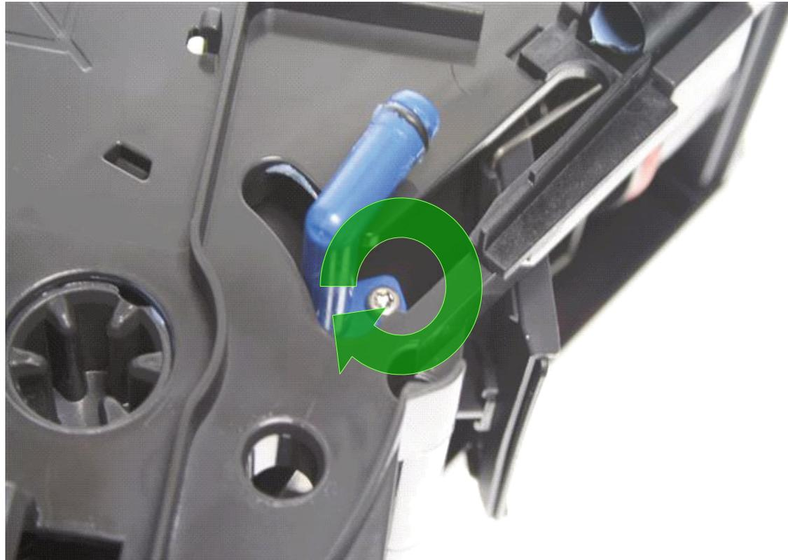
Jetzt die obere Schraube des Brühkammerzulaufs ebenfalls wieder anschrauben. Die Brühkammer nötigenfalls so schwenken, dass die Öffnung für die Schraube erreicht werden kann!
