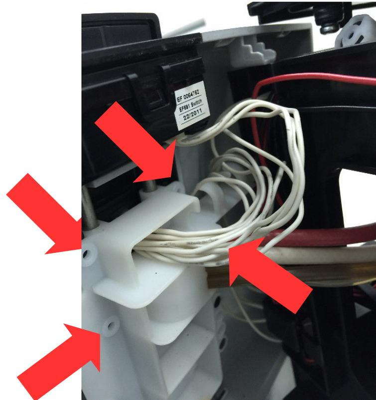
Schrauben Sie die vier Schrauben heraus, die den Auslaufschieber halten. (Auf der Abbildung ist dies bereits geschehen.)
