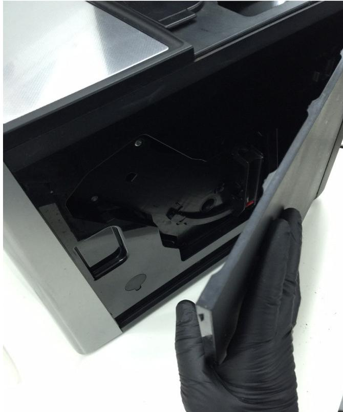
Als nächstes muss die Abdeckung der Brüheinheit entfernt werden.
