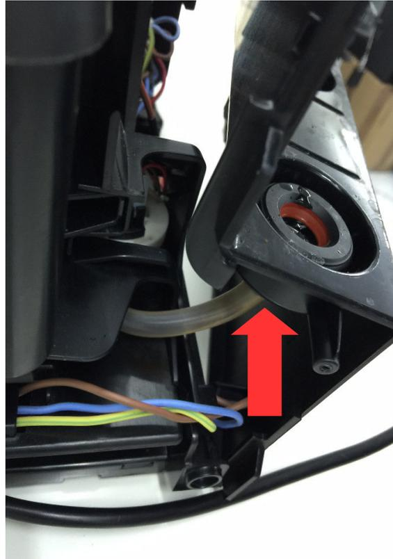
Ziehen Sie nun die Seitenteile nach oben heraus. Achten Sie darauf, dass auf der Wassertankseite noch der Schlauch zum Tanksockel entfernt werden muss.
