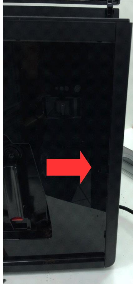
Lösen Sie auf der Seite mit der Brüheinheit die in der Abbildung markierte Arretierung, um die Rückwand dann von unten nach oben abnehmen zu können.
