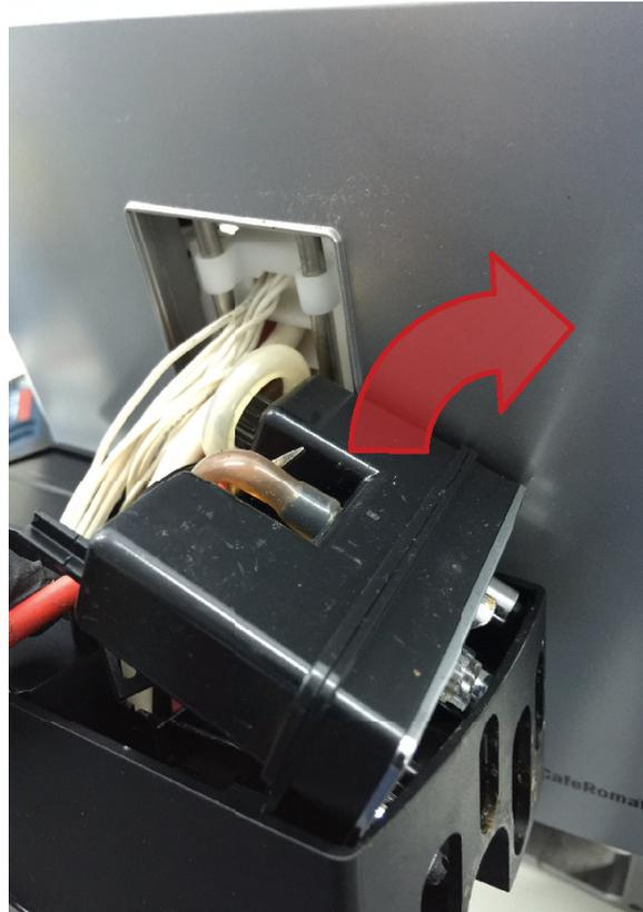
Jetzt den Auslauf aus dem Auslaufschieber aushebeln.
