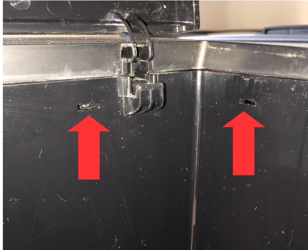
Heben Sie den Gehäusedeckel von hinten nach vorne an, um die Arretierungen genau in dieser Reihenfolge zu lösen. Auf der Abbildung sehen Sie die Arretierungen auf der Tankseite, lösen Sie mit einem schmalen Schlitzschraubenzieher die Haltenasen beim Anheben des Deckels. Gehen Sie auf der Seite mit der Brüheinheit genauso vor.
