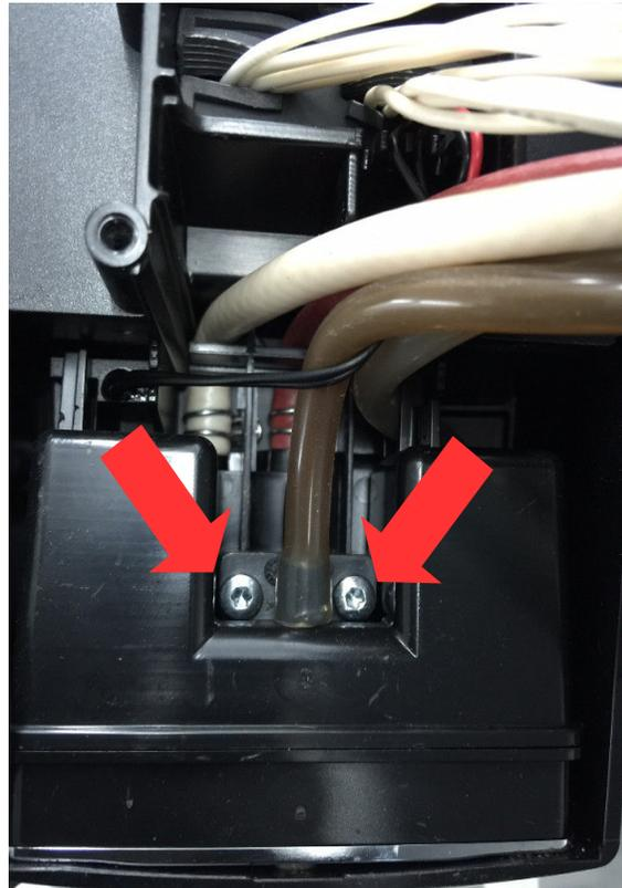
Die beiden markierten Schrauben fixieren den Auslauf und müssen entfernt werden.
