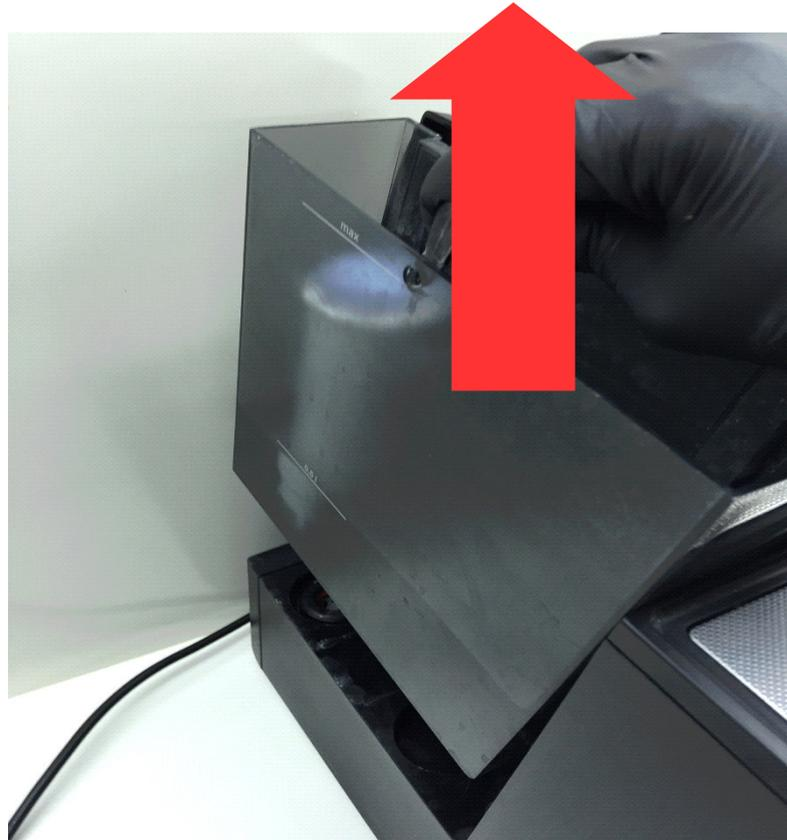
Entnehmen Sie im ersten Schritt den Wassertank.
