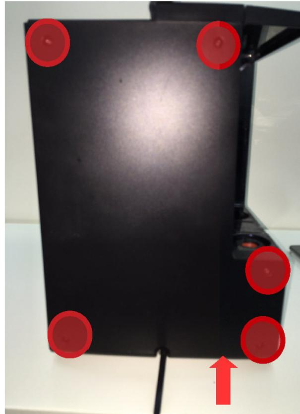
Entfernen Sie die fünf markierten Schrauben. An der mit einem Pfeil markierten Stelle wird jetzt die Rückwand am Gehäuseboden ausgehebelt.
