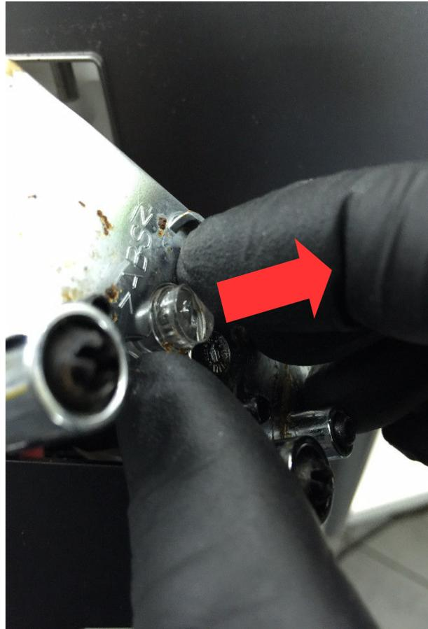
Ziehen sie als nächstes den Lichtleiter der Tassenbeleuchtung heraus und lösen Sie den Auslauf von der Chromabdeckung.
