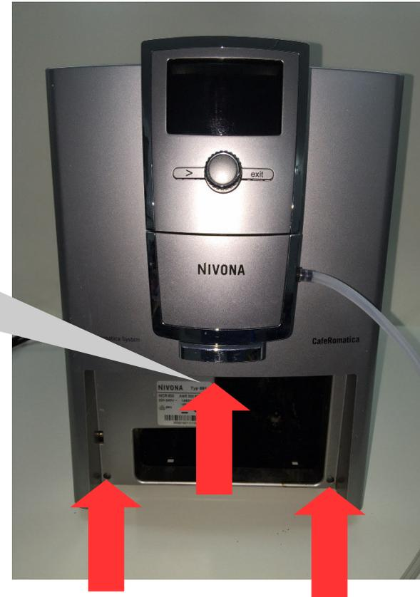
Als nächstes wird die Front demontiert. Schrauben Sie hierzu die drei Schrauben hinter der Auffangschale heraus.
