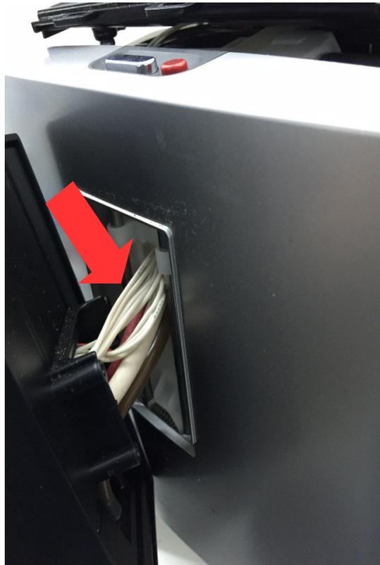
Drehen Sie jetzt den kompletten Auslaufschieber zur Seite. Achten Sie auch hier auf die Kabel!
