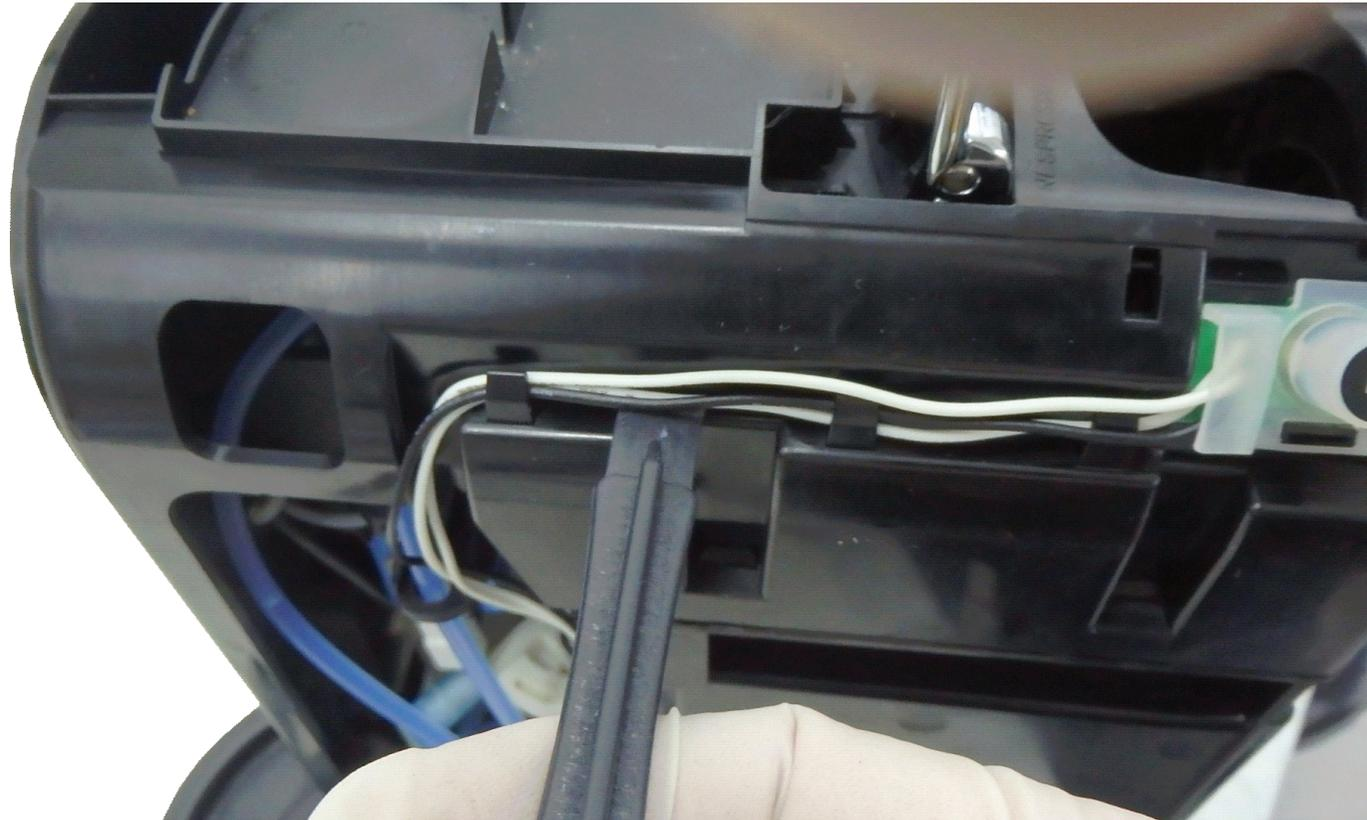
Hebeln Sie im nächsten Schritt auf der linken Seite die Kabel aus der Führung.
