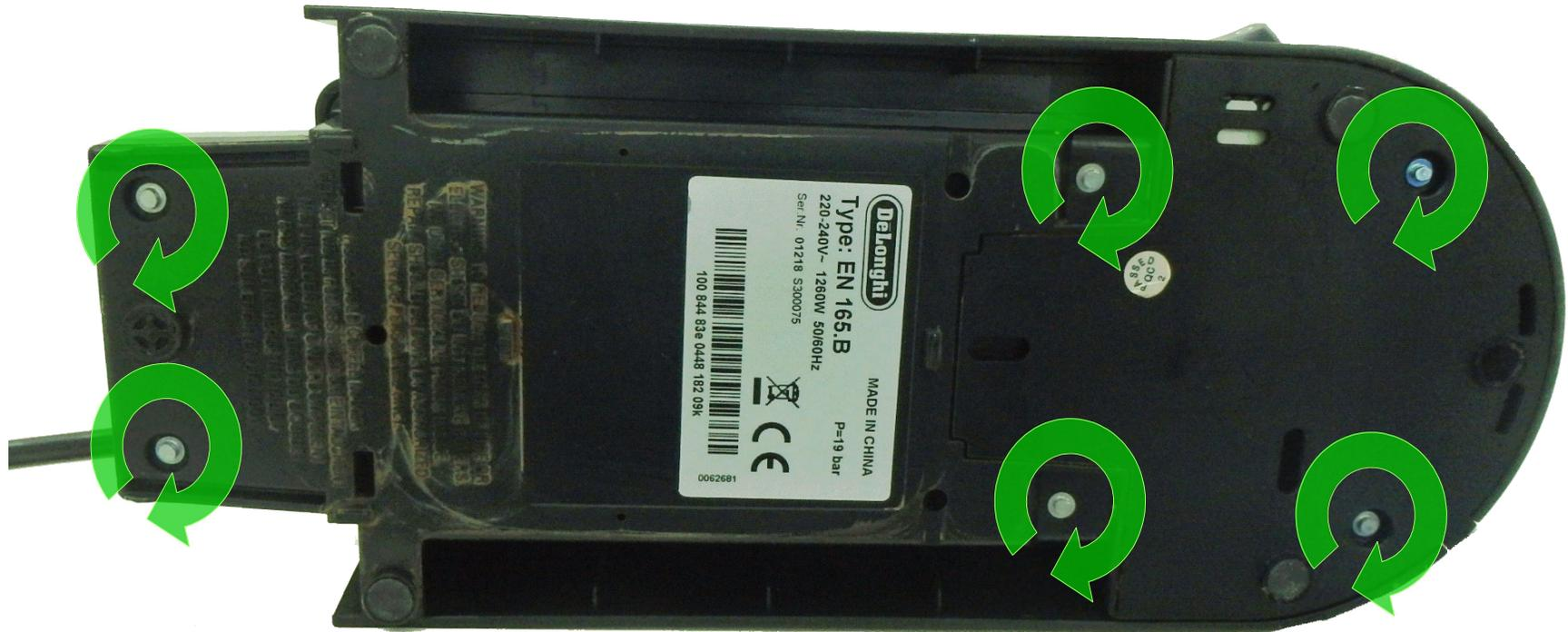
Legen Sie das Gerät auf die Seite, damit Sie die sechs Ovalschrauben besser befestigen können. Stellen Sie das Geräte daraufhin wieder aufrecht, um Kapsel- und Trester, sowie zum Abschluss den Wassertank wieder einzusetzen.
