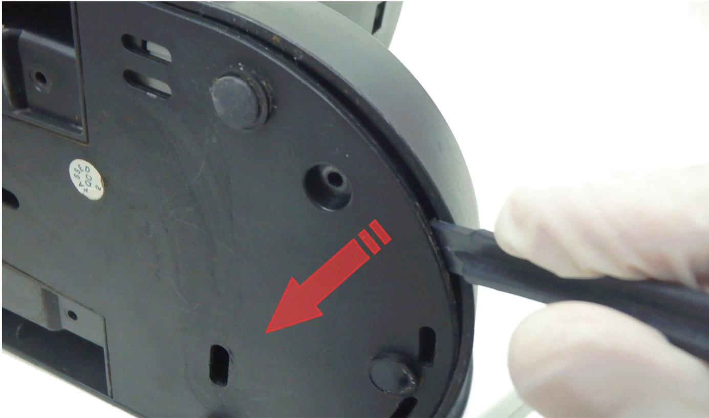
Entfernen Sie die untere Abdeckplatte, indem Sie diese mit Werkzeug aus Kunststoff heraushebeln. Da es hierfür oft kein spezielles Werkzeug in Privathaushalten gibt, hat sich der Einsatz von Smartphone bewährt. Ein Schraubenzieher geht natürlich auch, achten Sie aber darauf keine Kratzer zu verursachen.
