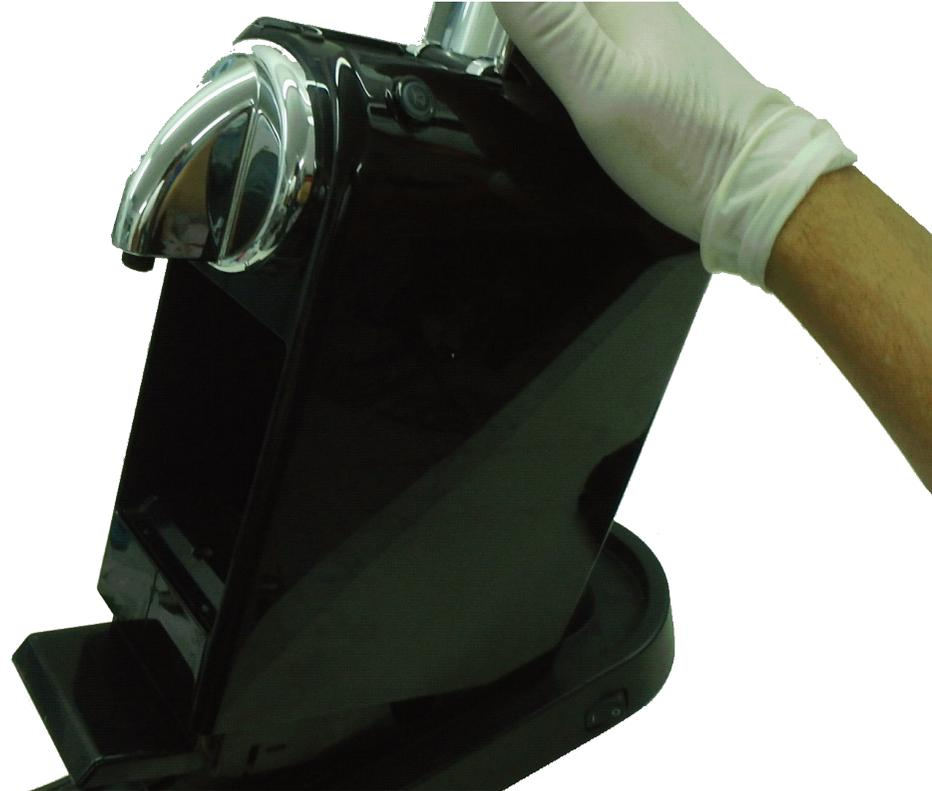
Die Bodenplatte ist nur aufgesteckt und kann mit etwas Kraft vom Gerät entfernt werden. Achten Sie aber darauf, dass wir bei der schnellen Zerlegung nicht die Verbindungsschläuche zum Tanksockel und Kabelverbindungen gelöst haben.
