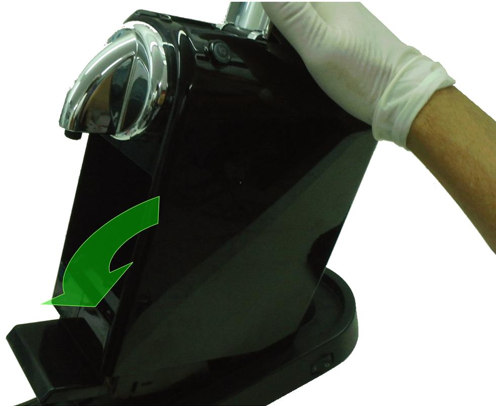
Jetzt das Gerät wieder in die Bodenplatte stecken. Passen Sie auf, dass keine Kabel oder Schläuche gequetscht werden.
