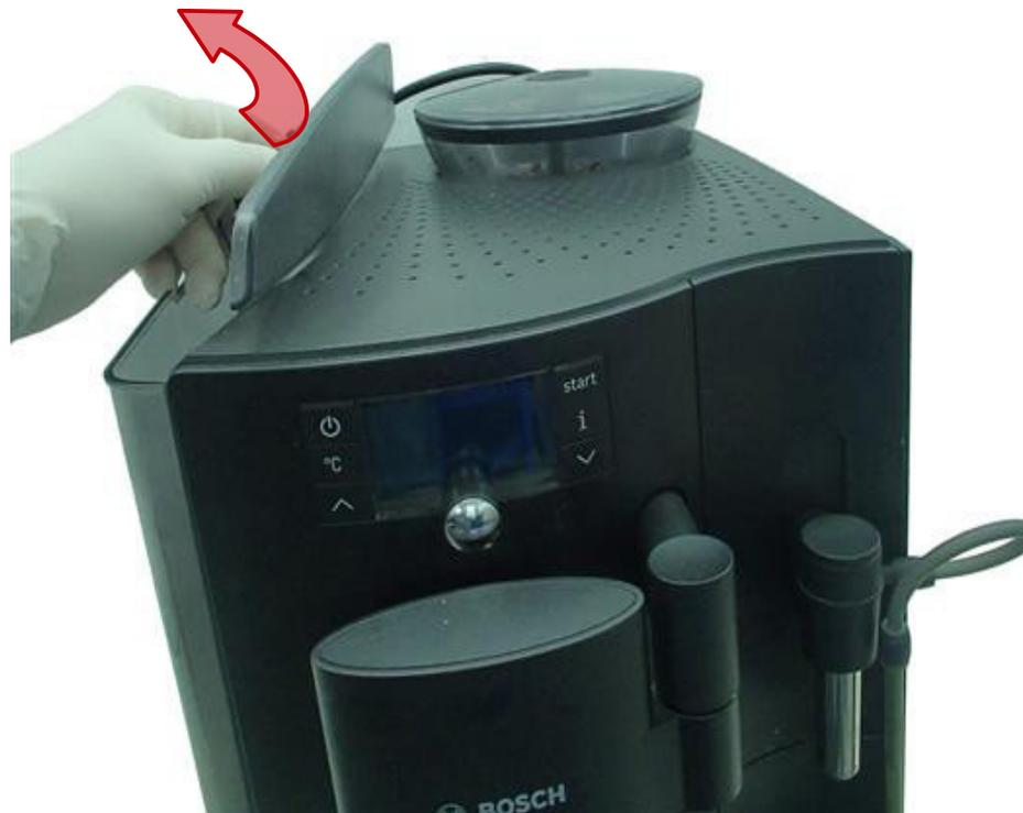
Entfernen Sie im 1. Schritt den Wassertank.
