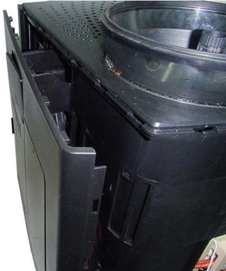
Lassen Sie die Seitenwand an der Pulverschublade hängen, ansonsten können Sie diese aber komplett ablösen.
