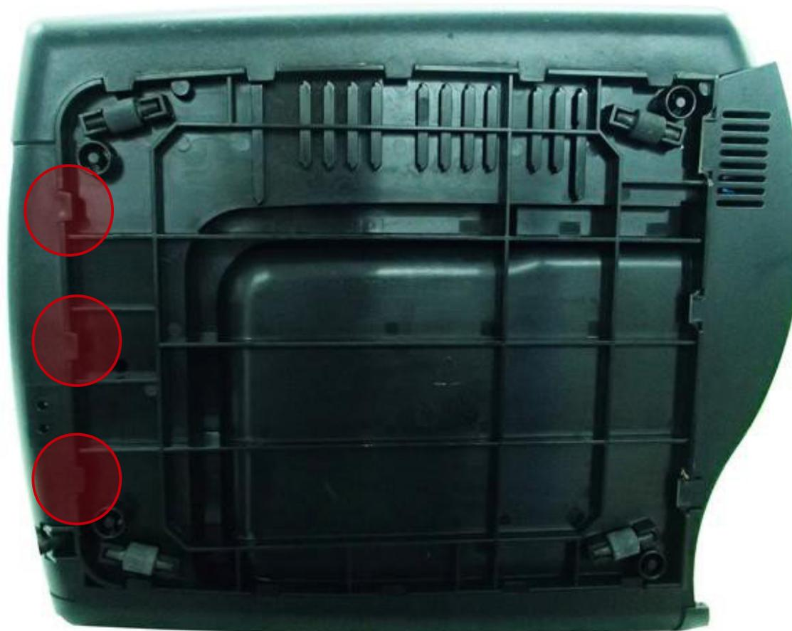
Entfernen Sie zunächst die Rückwand, in dem Sie die hier markierten Haltenasen lösen.
