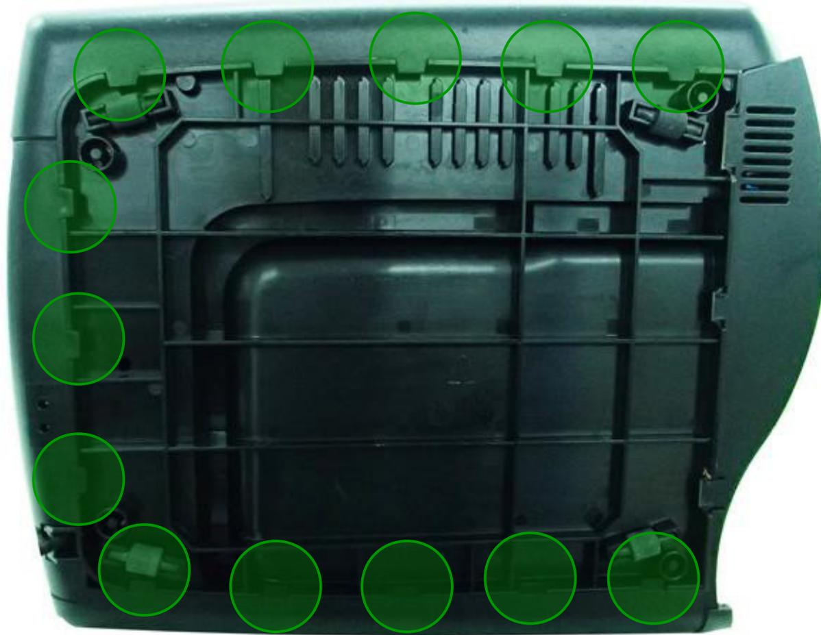
Befestigen Sie auch die zweite Seitenwand auf die gleiche Weise, bis beide mit der Rückwand abschließen. Achten Sie darauf das alle in der Abbildung markierten Haltenasen eingerastet sind.
