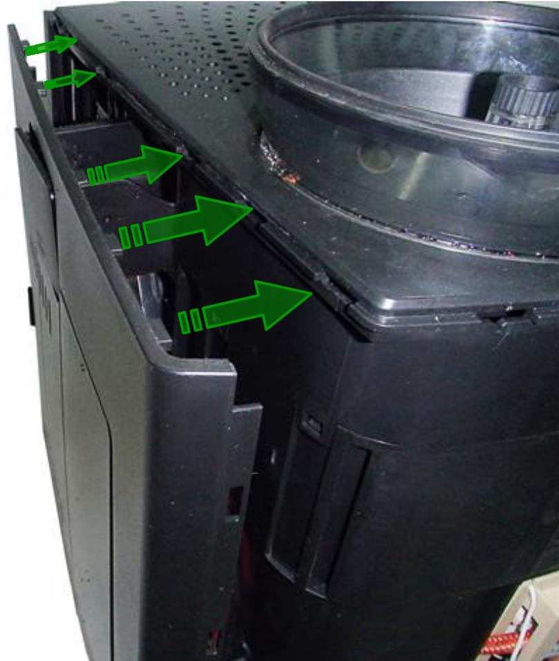
Befestigen Sie jetzt die erste Seitenwand wieder. Stecken Sie dafür die Haltenasen in die vorgesehenen Öffnungen, bis diese hörbar einrasten. Gehen Sie von oben nach unten vor.
