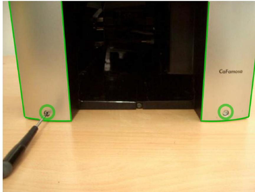
Fixieren Sie die Blende, indem Sie die beiden Schrauben am unteren Ende festschrauben.
