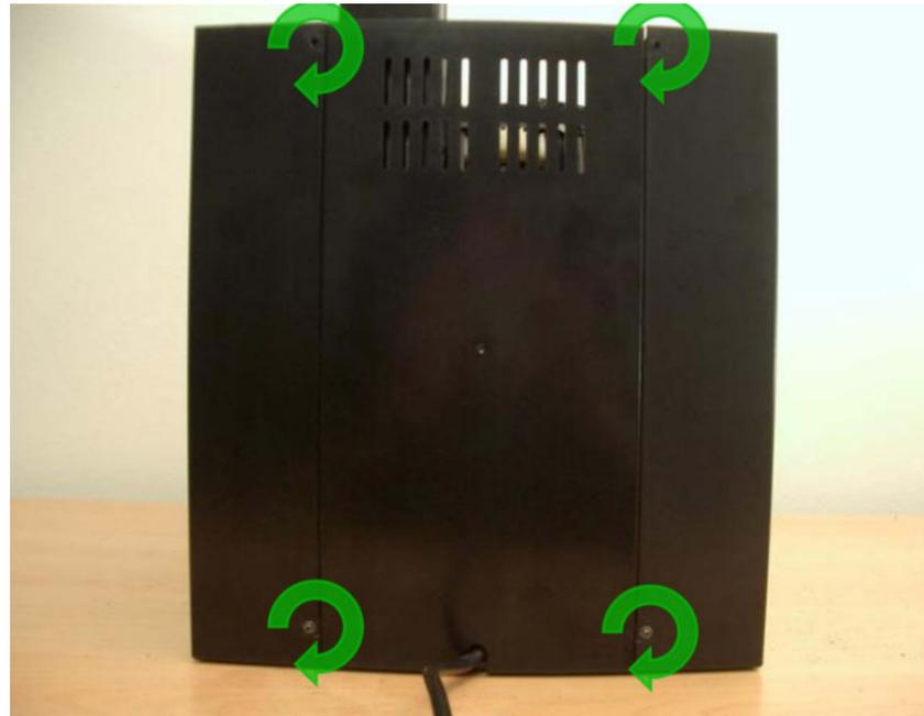
Befestigen Sie die Rückwand, indem Sie die vier Ovaleckschrauben wieder eindrehen.
