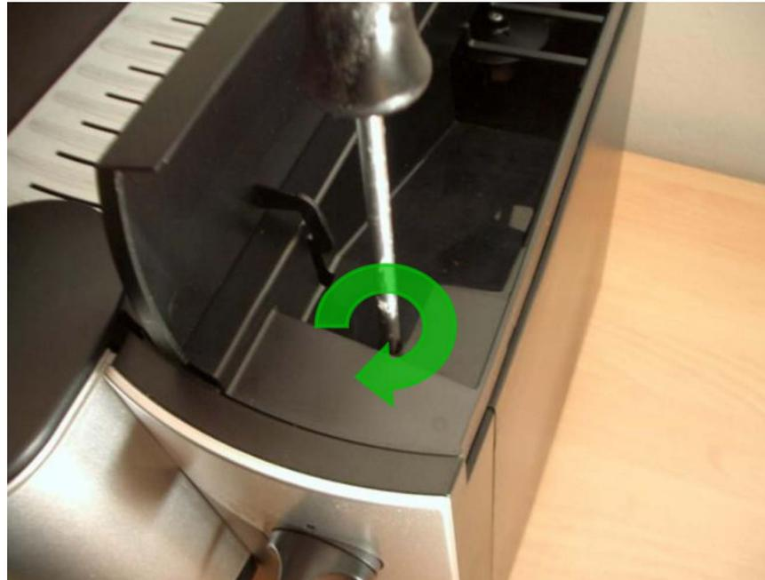
Drehen Sie jetzt die Schraube an der Vorderfront des Pulverschichtes wieder ein.
