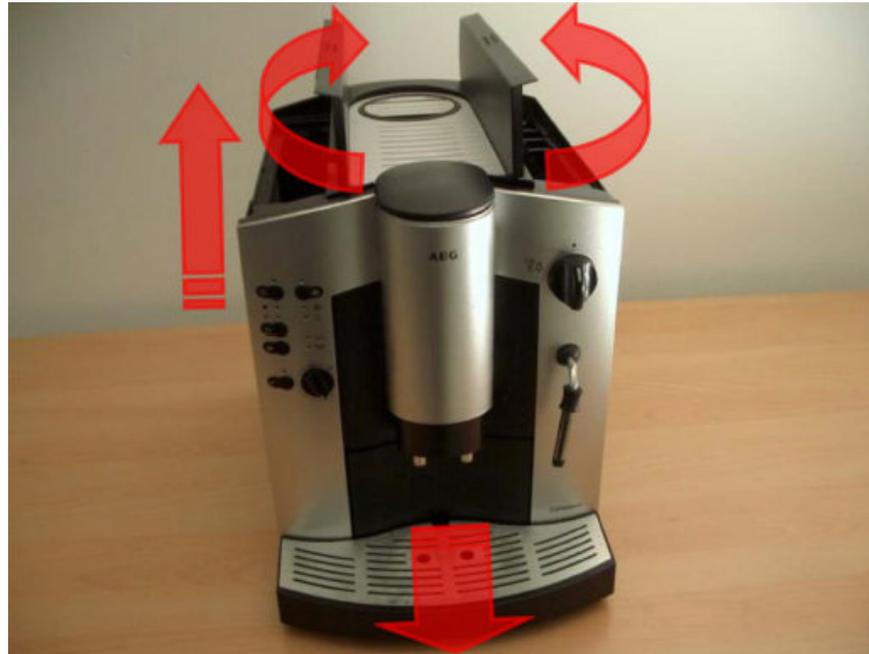
Entfernen Sie zuerst die Tropfschale zusammen mit den Trester. Im nächsten Schritt klappen Sie die beiden Deckel an den Seiten (Kaffeebohnen und Wasserbehälter) hoch. Nehmen Sie dann den Wassertank heraus.
