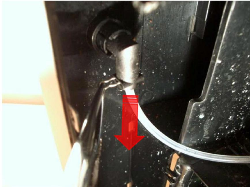
Entfernen Sie auf der Rückseite des Dampfrohrs die Anschlussleitung. Entnehmen Sie dann das Verbindungsstück des Dampf-/Heißwasserdrehschalters auf der Gehäuserückseite.
