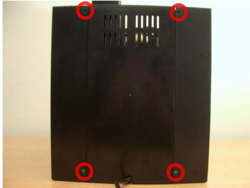
Entfernen Sie im nächsten Schritt die vier auf der Abbildung zu sehenden **Ovalkopfschrauben** auf der Geräterückseite.
