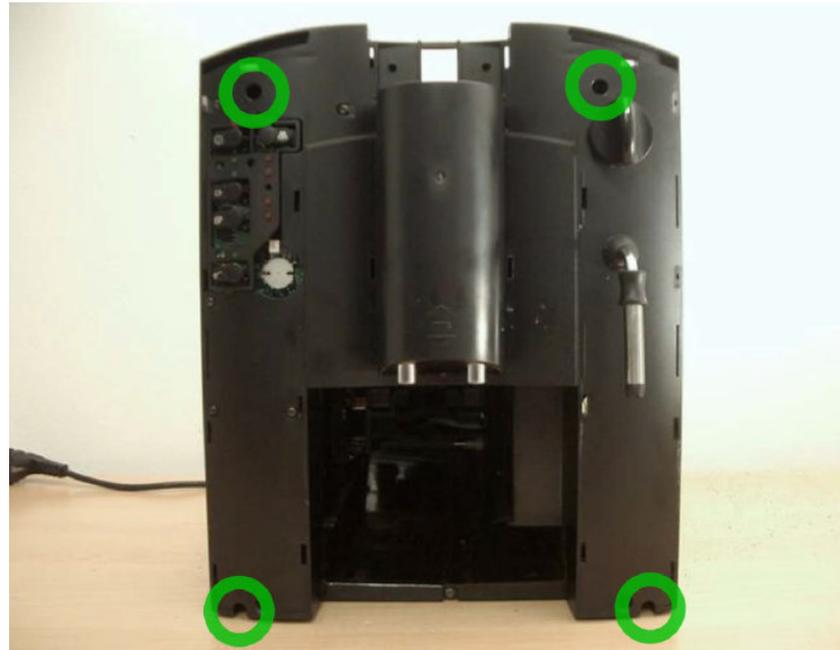
Befestigen Sie die Vorderfront, in dem Sie die vier Schrauben wieder festziehen.
