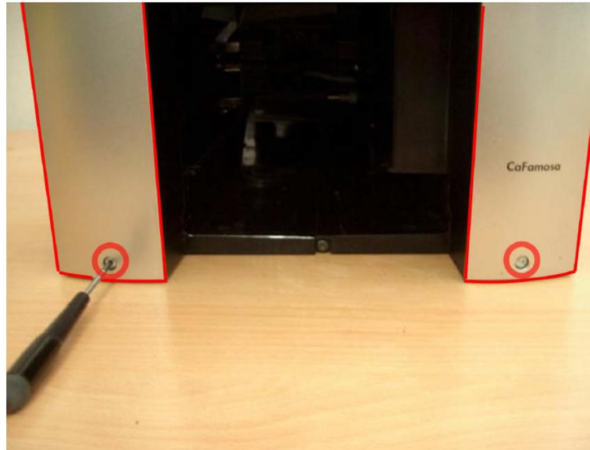
Lösen Sie die beiden Schrauben unten an der Front des Kaffeevollautomaten.
