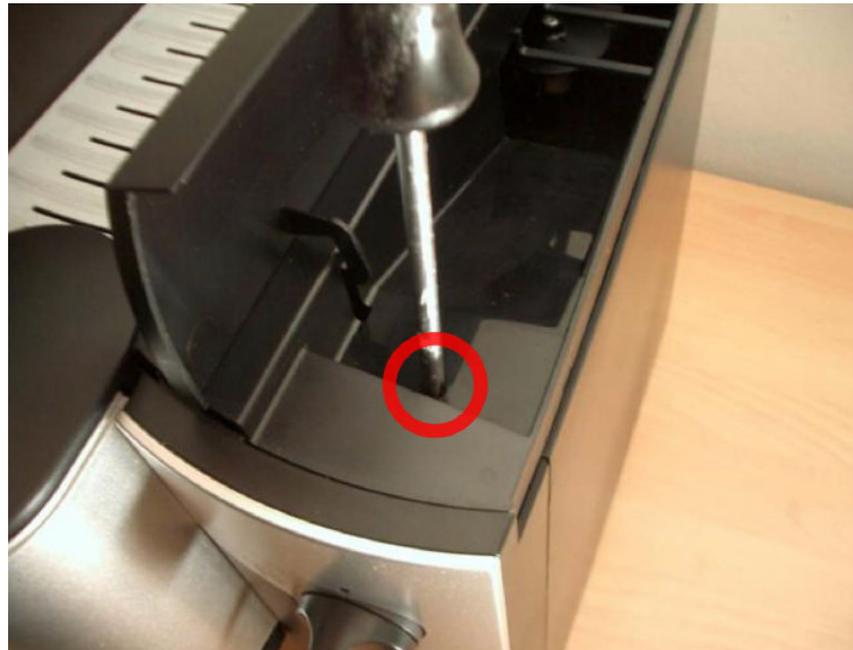
Lösen Sie die zweite Schraube, sie sitzt an der Vorderseite des Pulverschachtes.
