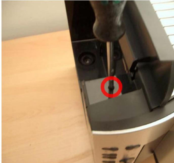
Entfernen Sie auf der Seite des Wassertank die vordere Schraube (Torx 10).
