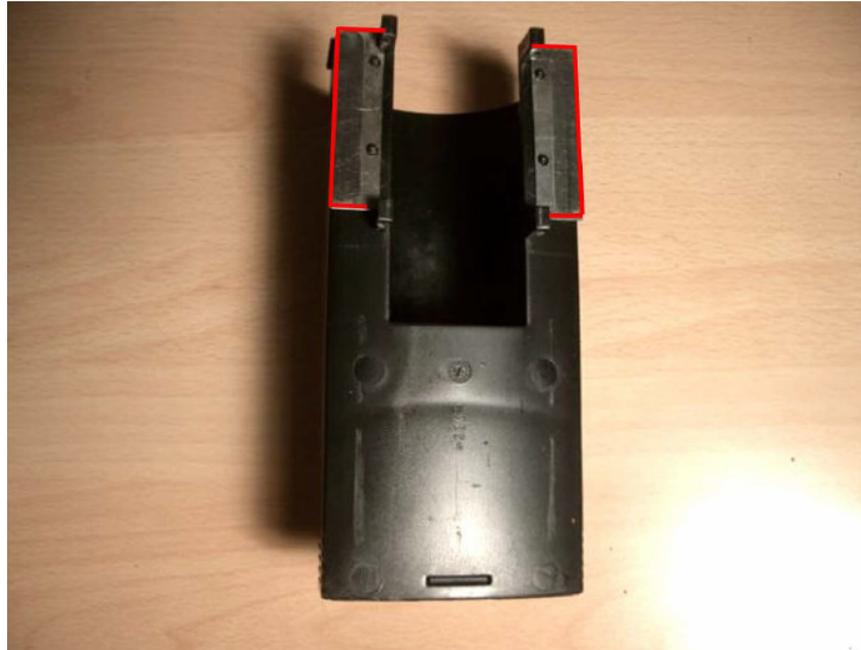
Auf der Abbildung sehen Sie den ausgebauten Auslauf mit den Metallplättchen, die von den Magneten an Position gehalten werden.
