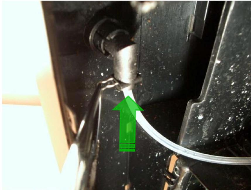
Schließen Sie jetzt auf der Rückseite des Dampfrohrs den Schlauch wieder an. Vergessen Sie dabei nicht den O-Ring!
