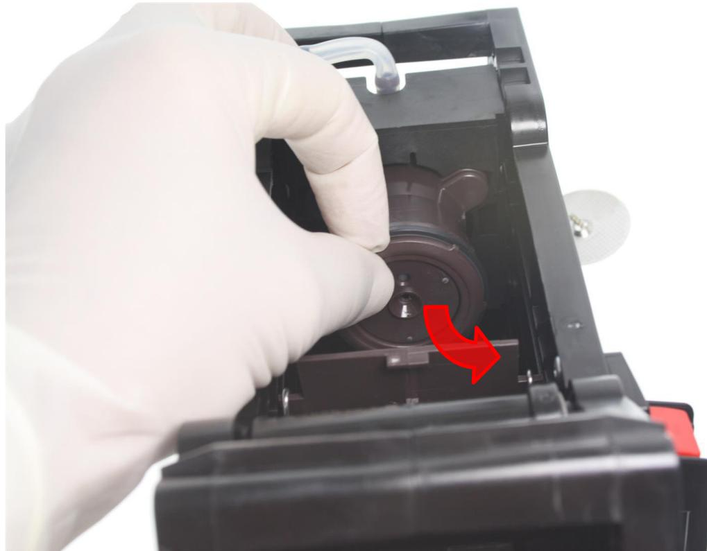
Entfernen Sie jetzt den in der Abbildung zu sehenden Haltering zwischen Sieb und Lippendichtung.
