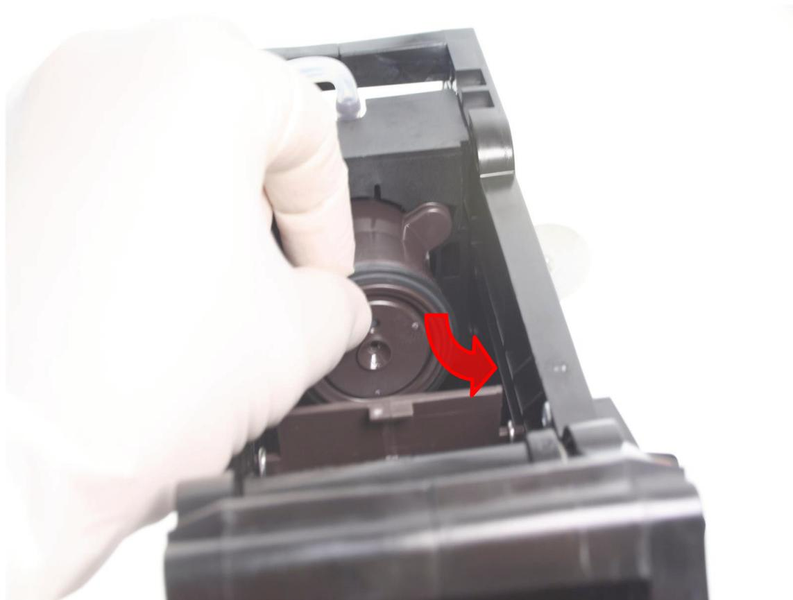
Entfernen und entsorgen Sie als nächstes die Lippendichtung selbst.
