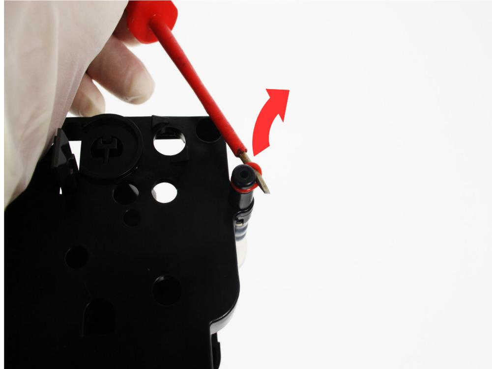
Im nächsten Schritt entfernen Sie die Dichtung am Auslaufstutzen und entsorgen diese.
