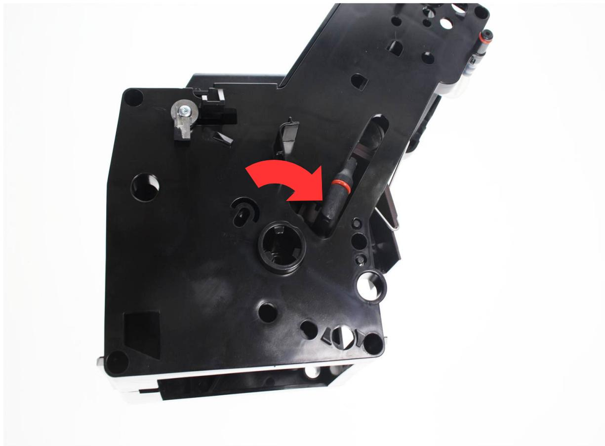
Schwenken Sie den unteren Kolben so, dass der Zulaufstutzen frei zugänglich ist.
