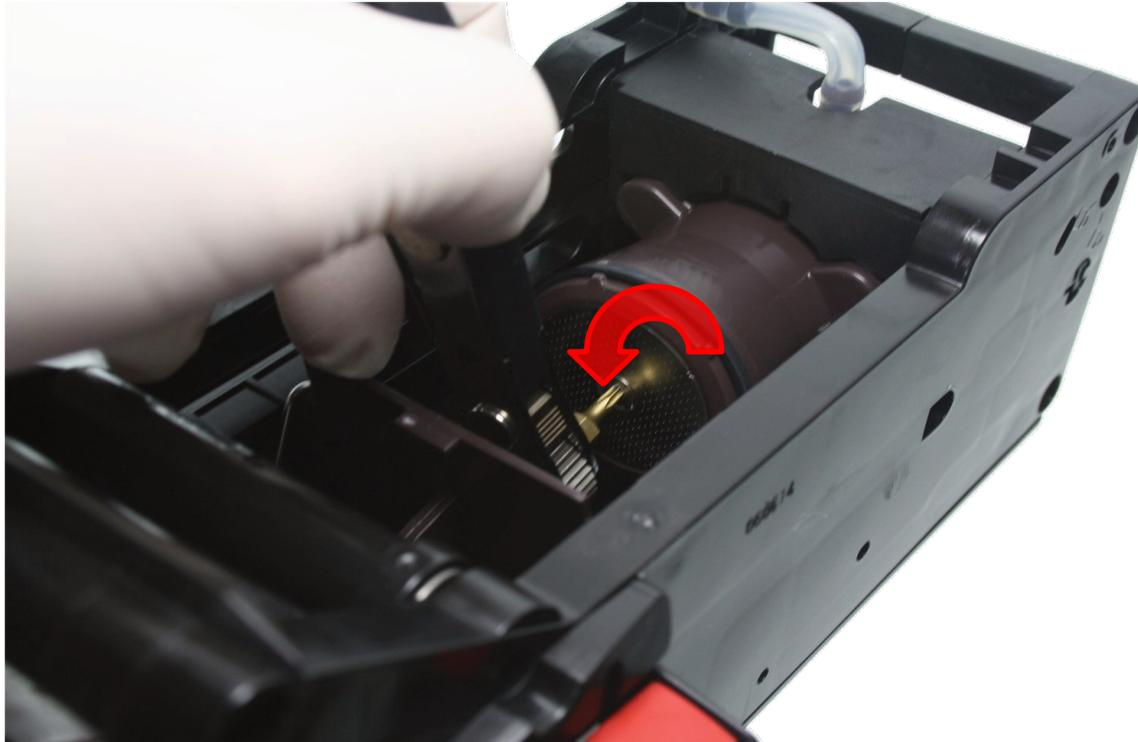
Entfernen Sie zuerst mit einer kleinen Ratsche (Knarre) das Brühsieb und reinigen Sie es gründlich von Fetten und anderen Verschmutzungen. Prüfen Sie im Anschluss, ob das Sieb ersetzt werden muss.
