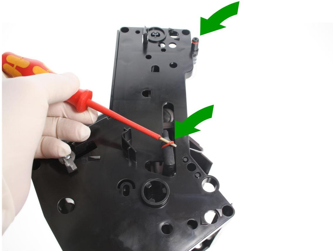
Ziehen Sie die neuen Dichtungsringe an Ein- und Auslaufstutzen auf.
