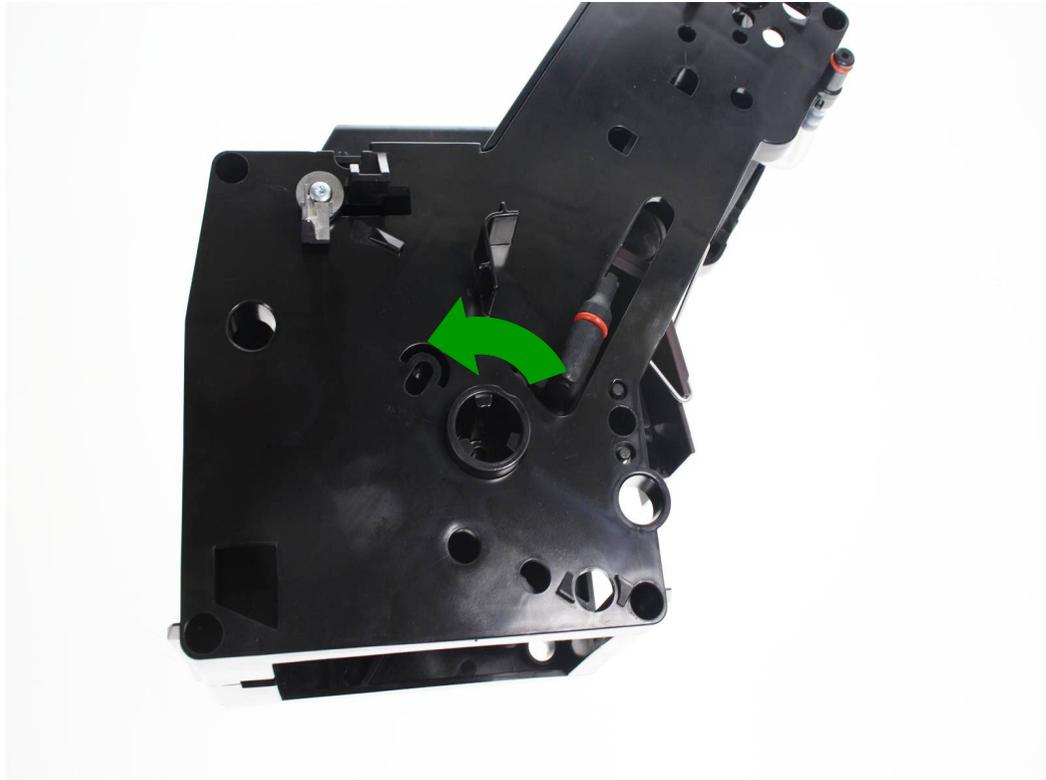
Schwenken Sie den untern Kolben jetzt wieder so weit zurück, bis sich der Zulaufstutzen wieder in der Parkposition befindet.
