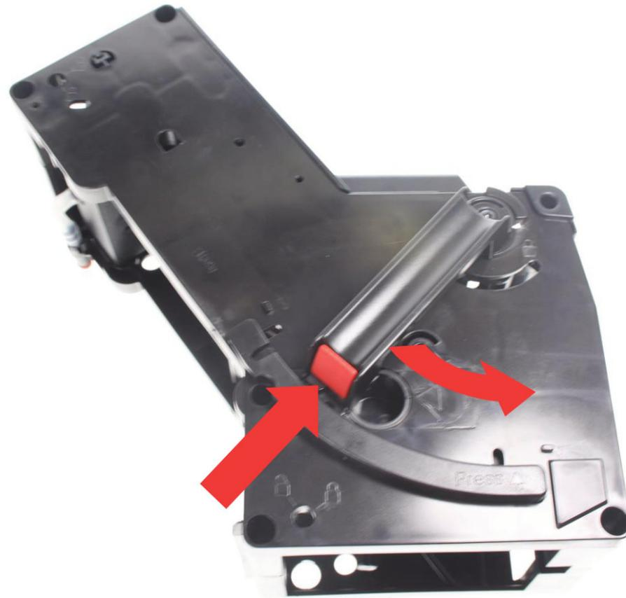
Bewegen Sie den Verschlusshebel jetzt im Uhrzeigersinn. Nur so lässt sich der unter Kolben schwenken, um die Dichtung des Zulaufstutzens zu tauschen.
