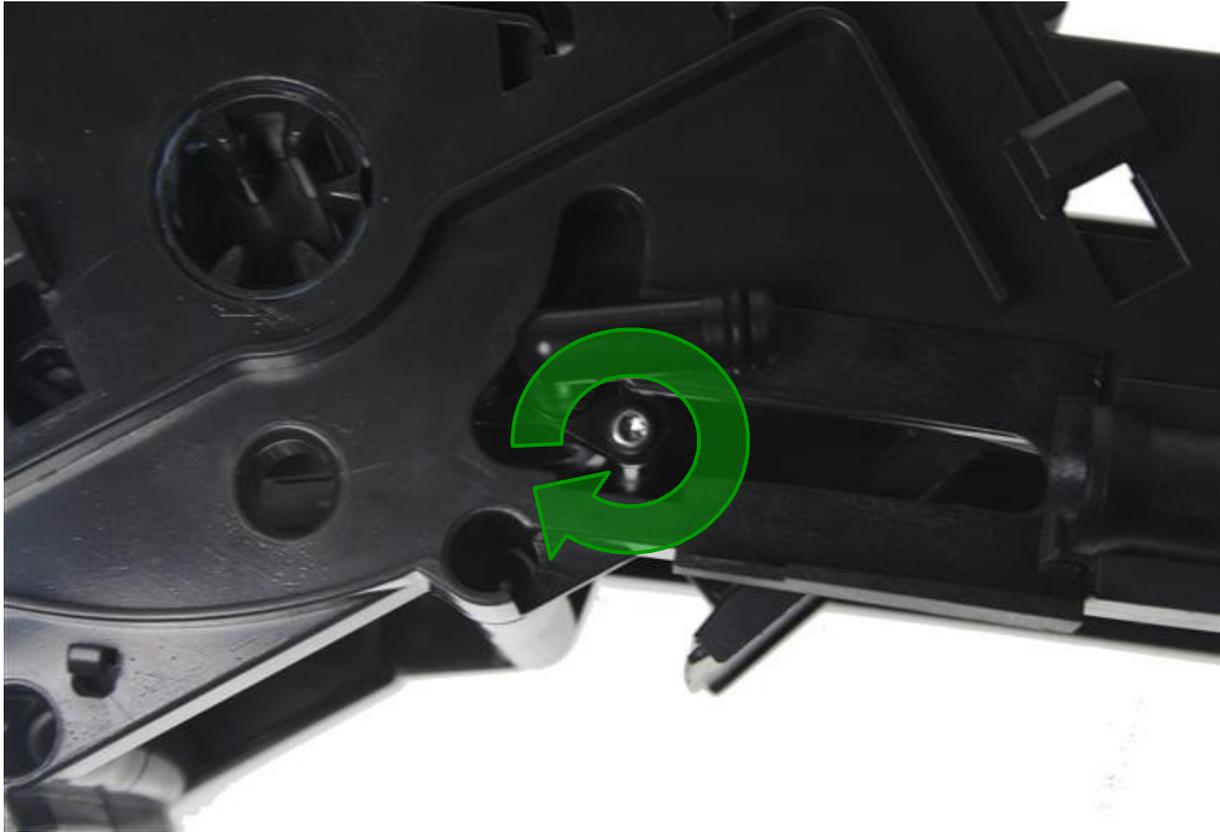
Schwenken Sie die Brühkammer so lange, bis die obere Schraube des Brühkammerzulaufs eingesetzt und festgeschraubt werden kann.
