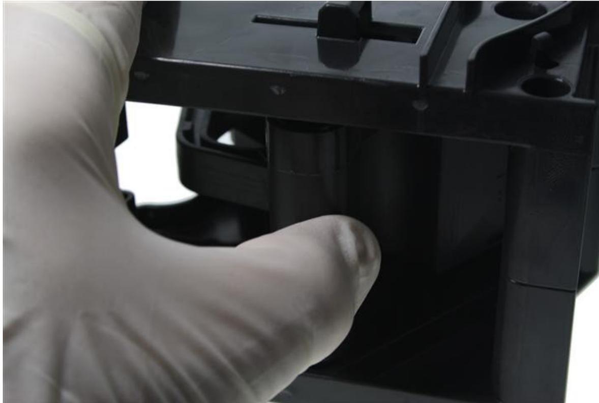
Nun die Brühkammer so weit schwenken, dass die obere Schraube des Andockstücks sichtbar wird.
