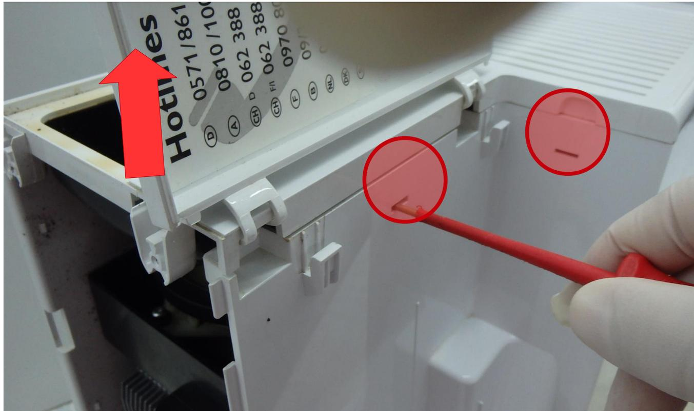
Beginnen Sie mit einem schmalen Schlitzschraubenzieher von der Geräterückseite aus auf beiden Seiten die Arretierungen zu lösen und dabei die Abdeckung nach oben zu ziehen.
