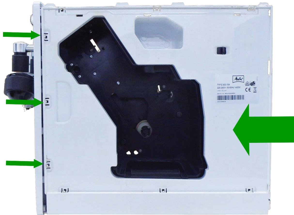
Schieben Sie das Seitenteil auf der Seite der Brühgruppe von hinten nach vorn ein, bis es hörbar einrastet. Es muss an der Front bündig abschließen.
