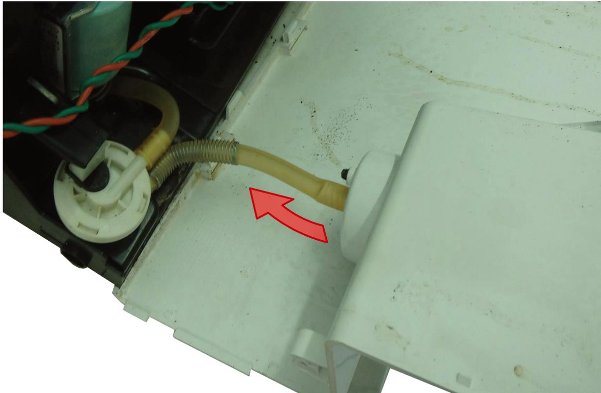
Das Seitenteil an der Wassertankseite ist noch mit dem Tank verbunden. Der Schlauch ist allerdings nur aufgesteckt und lässt sich entsprechend einfach lösen.
