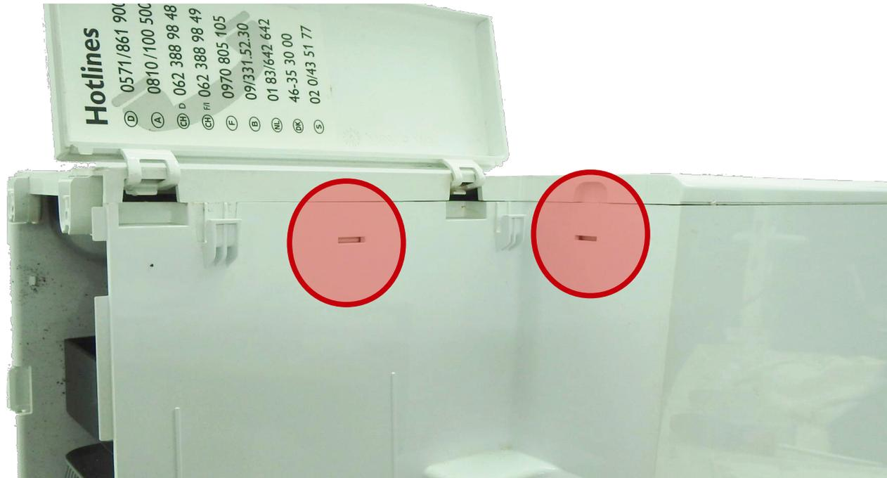
Hier sind die Arretierungen auf der Seite des Wassertanks markiert, lösen Sie auch diese wie in der folgenden Abbildung beschrieben.
