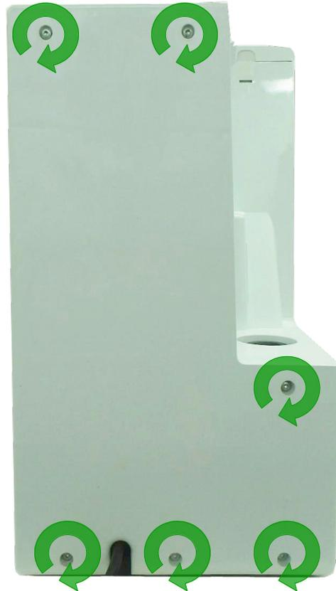
Als letzter Schritt müssen die Torx-Schrauben der Rückwand wieder eingeschraubt werden.
