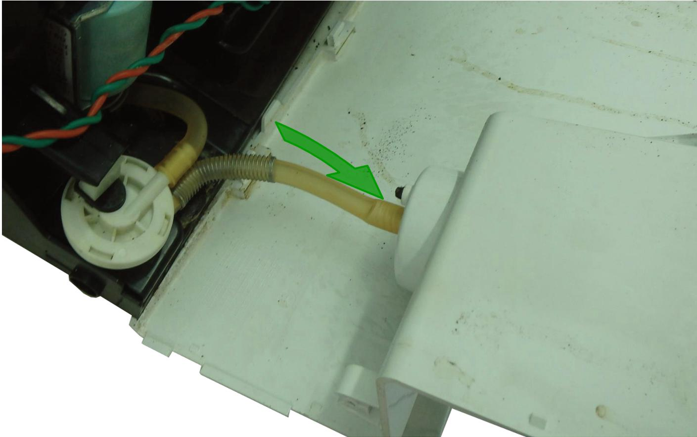
Bevor Sie das Seitenteil auf der anderen Seite einsetzen können, müssen sie erst den Schlauch zum Wassertank wieder anschließen.
