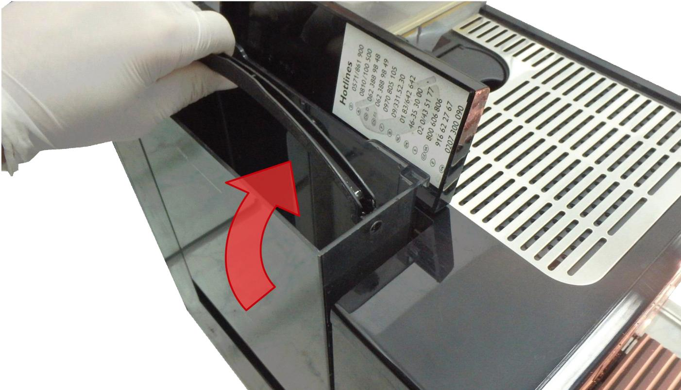
Entfernen Sie im ersten Schritt den Wassertank und danach die Tropfschale.
