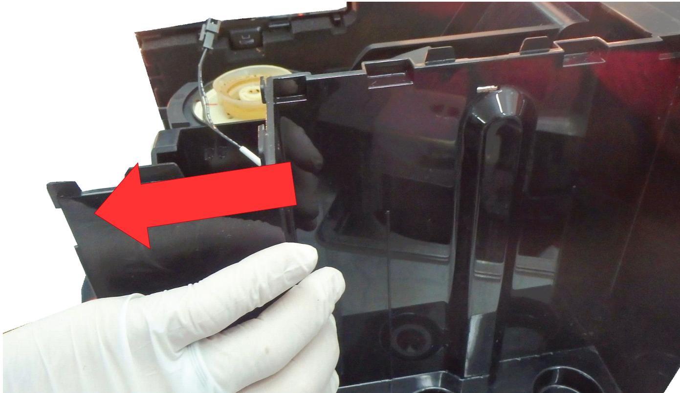
Beim Seitenteil für den Wassertank müssen Sie auf mehrere Dinge achten, wenn Sie es vorsichtig abziehen. Achten Sie auf die Kabel des daran befestigten Einschalters, außerdem ist der Wasseranschluss und der Sensor für den Schwimmer dort befestigt.
