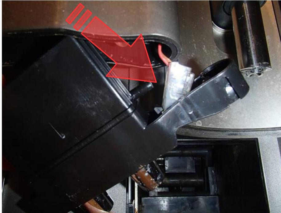
Jetzt müssen Sie nur noch das Beleuchtungsmodul aushaken und der Auslaufverteiler ist ausgebaut.
