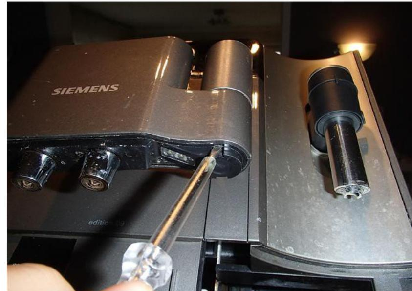
Hebeln Sie den Auslaufverteiler nicht mit aller Gewalt heraus, sondern am besten immer abwechselnd an beiden Seite etwas hebeln. So geht es am einfachsten.
