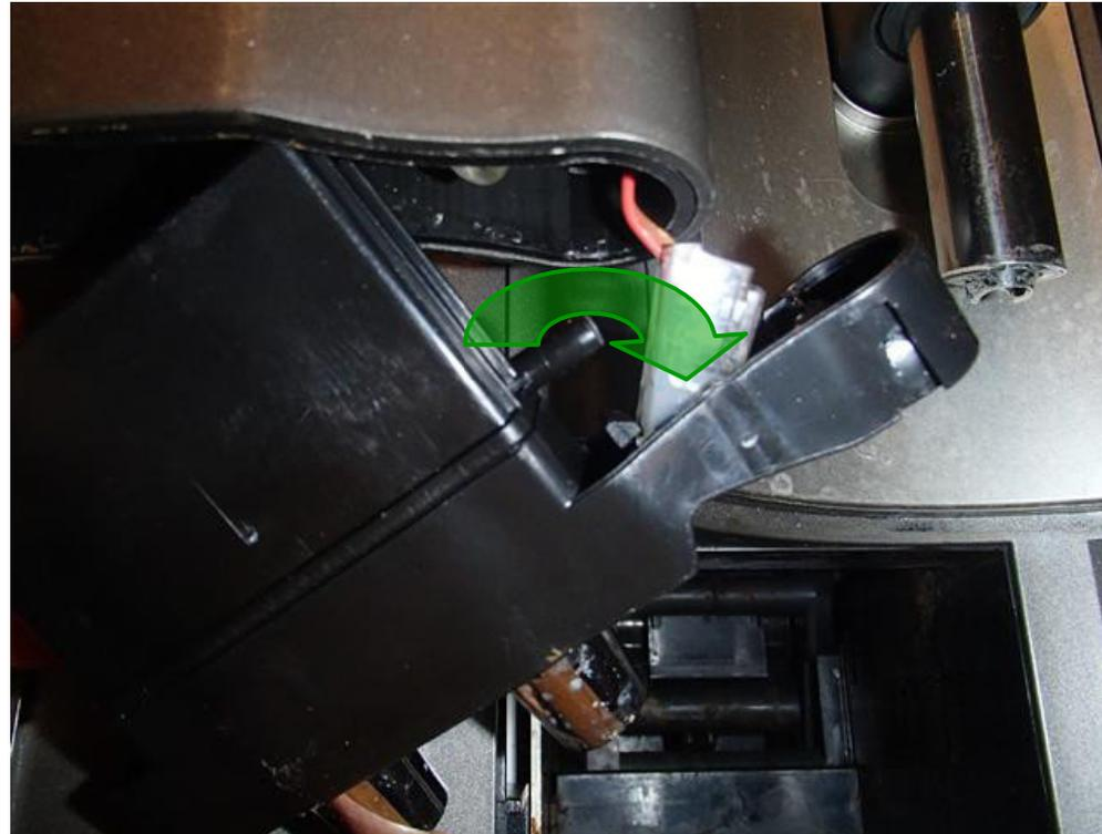
Verbinden Sie beim Wiedereinbau zuerst den Auslaufverteiler wieder mit dem Beleuchtungsmodul.
