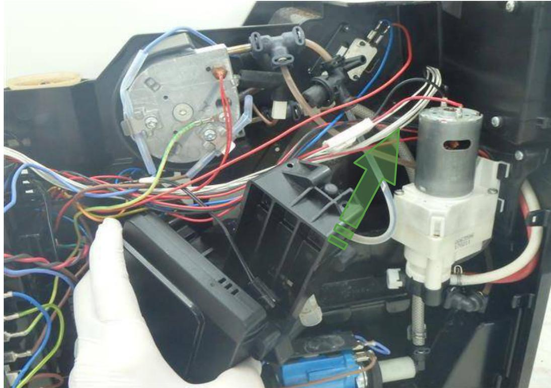
Setzen Sie nun den Antrieb wieder in die korrekte Position. Achten Sie darauf, dass kein Kabel zwischen Antrieb und Gehäuse eingeklemmt wird.
