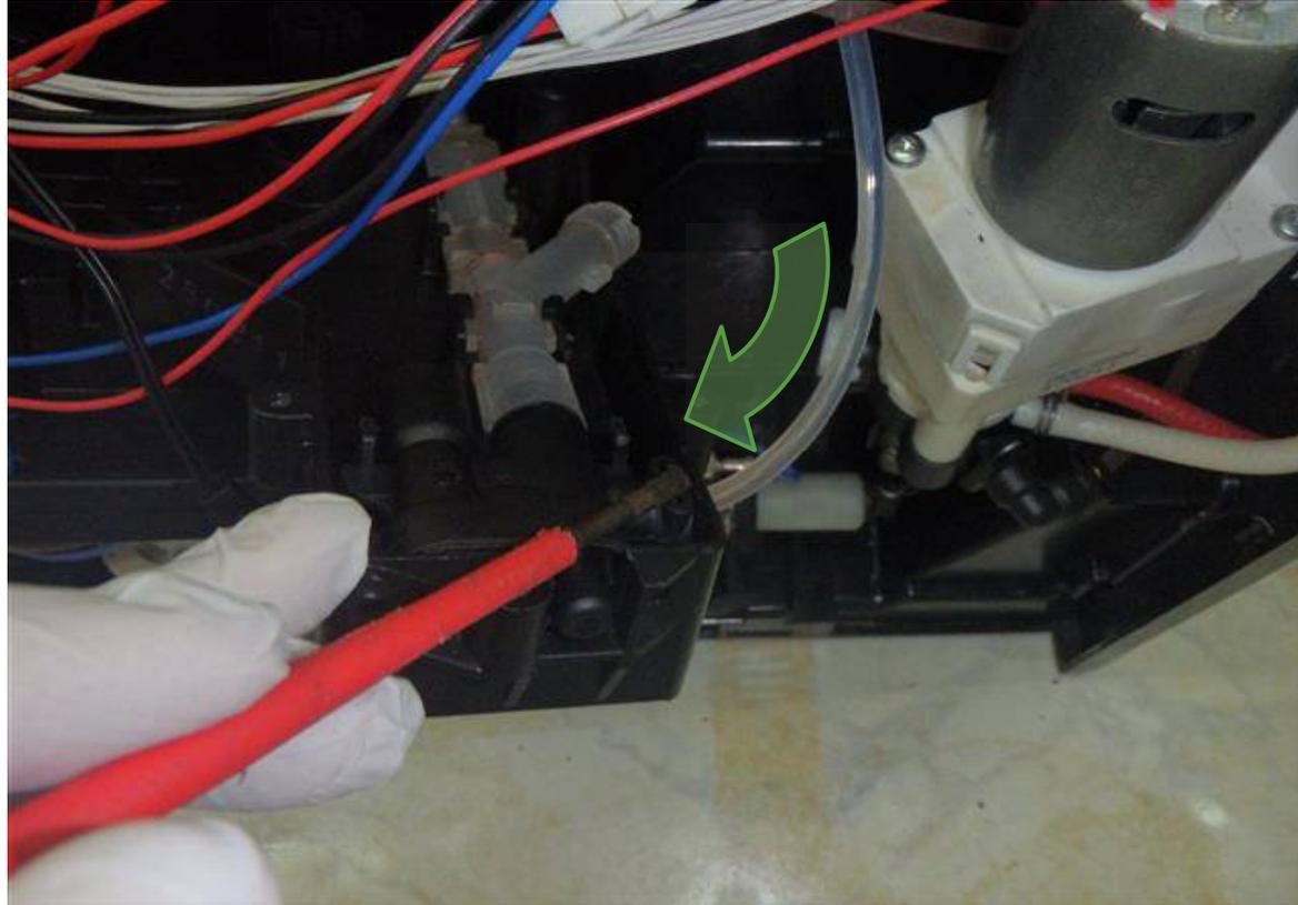
Den Fluidschlauch wieder in den Anschluss des Drainageventils stecken und mit der Halteklammer sichern.
