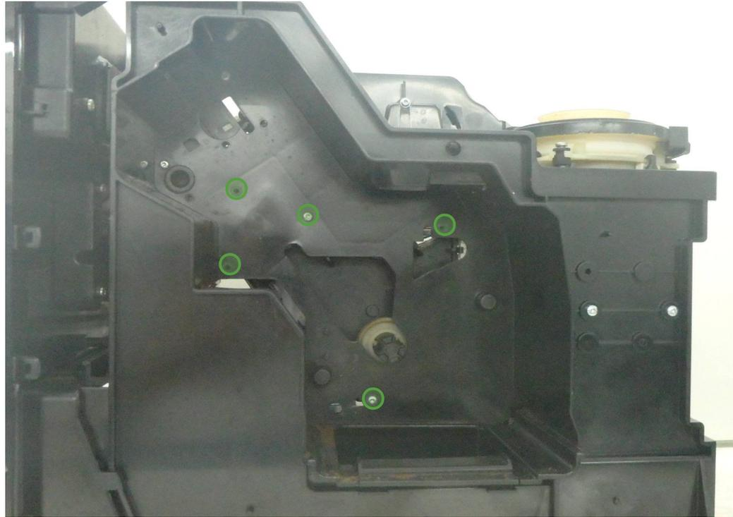
Drehen Sie das Gerät nun wieder um, und besfestigen Sie den Antrieb mit den gekennzeichneten fünf Schrauben. Vergessen Sie nicht, auch die Expansionskammer wieder aufzustecken.
