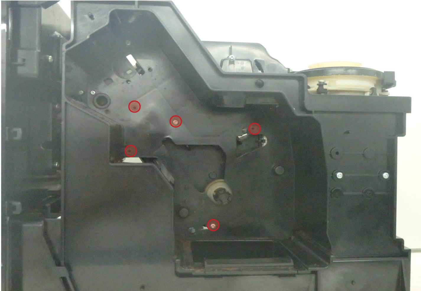
Der Antrieb ist mit insgesamt fünf Schrauben befestigt, hier rot markiert. Entfernen Sie bitte nur diese fünf Schrauben.
