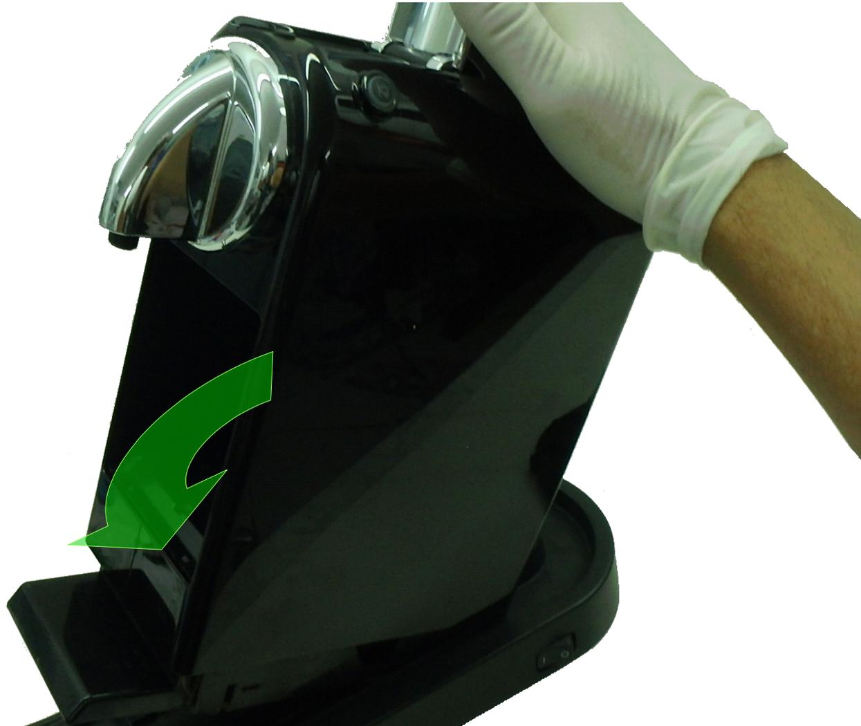
Die Abdeckplatte unter dem Tanksockel wieder einsetzen, einrasten lassen und mit demOvalkopfschrauben befestigen.
