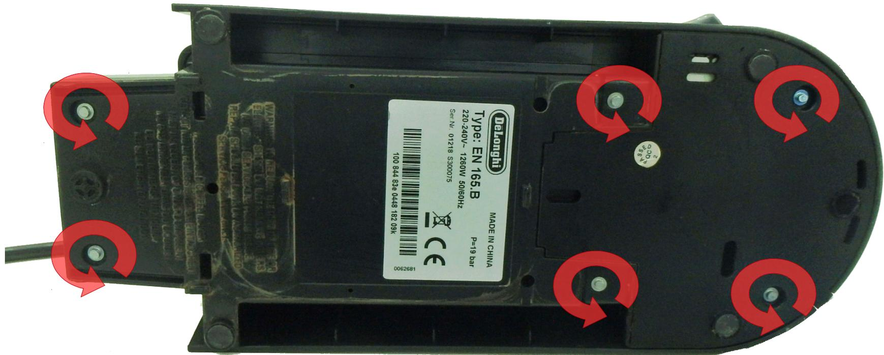
Entfernen Sie die Abdeckplatte unter dem Tanksockel mit einem geeigneten Kunststoff-Werkzeug. Im Werkstatt Bereich haben sich die Hebelwerkzeuge, die bei Handy-Reparatursets mitgeliefert werden, bewährt.
