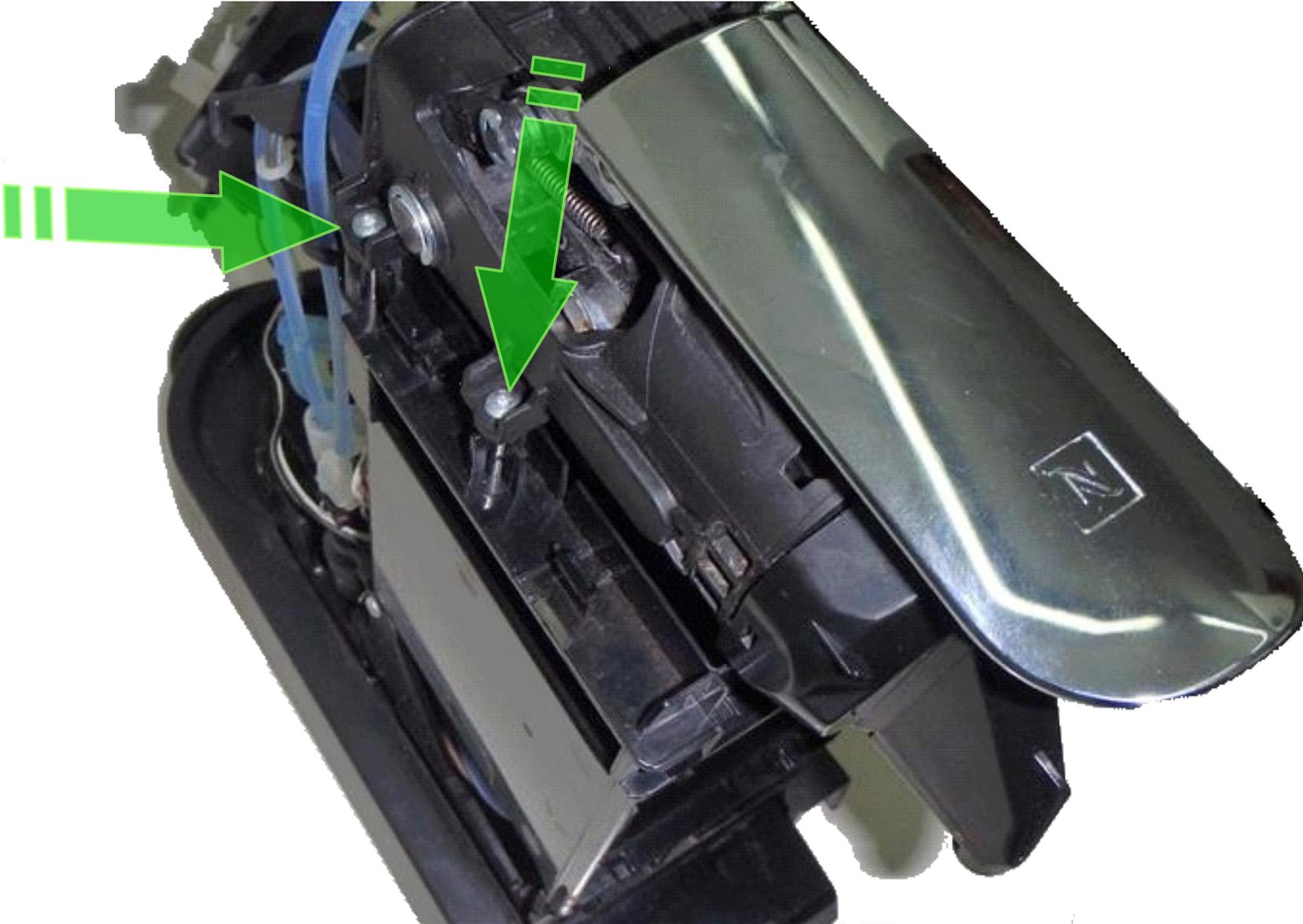
Den Schlauch wieder in die Zuleitung der Brüheinheit stecken und mit der Halteklammer sichern.
