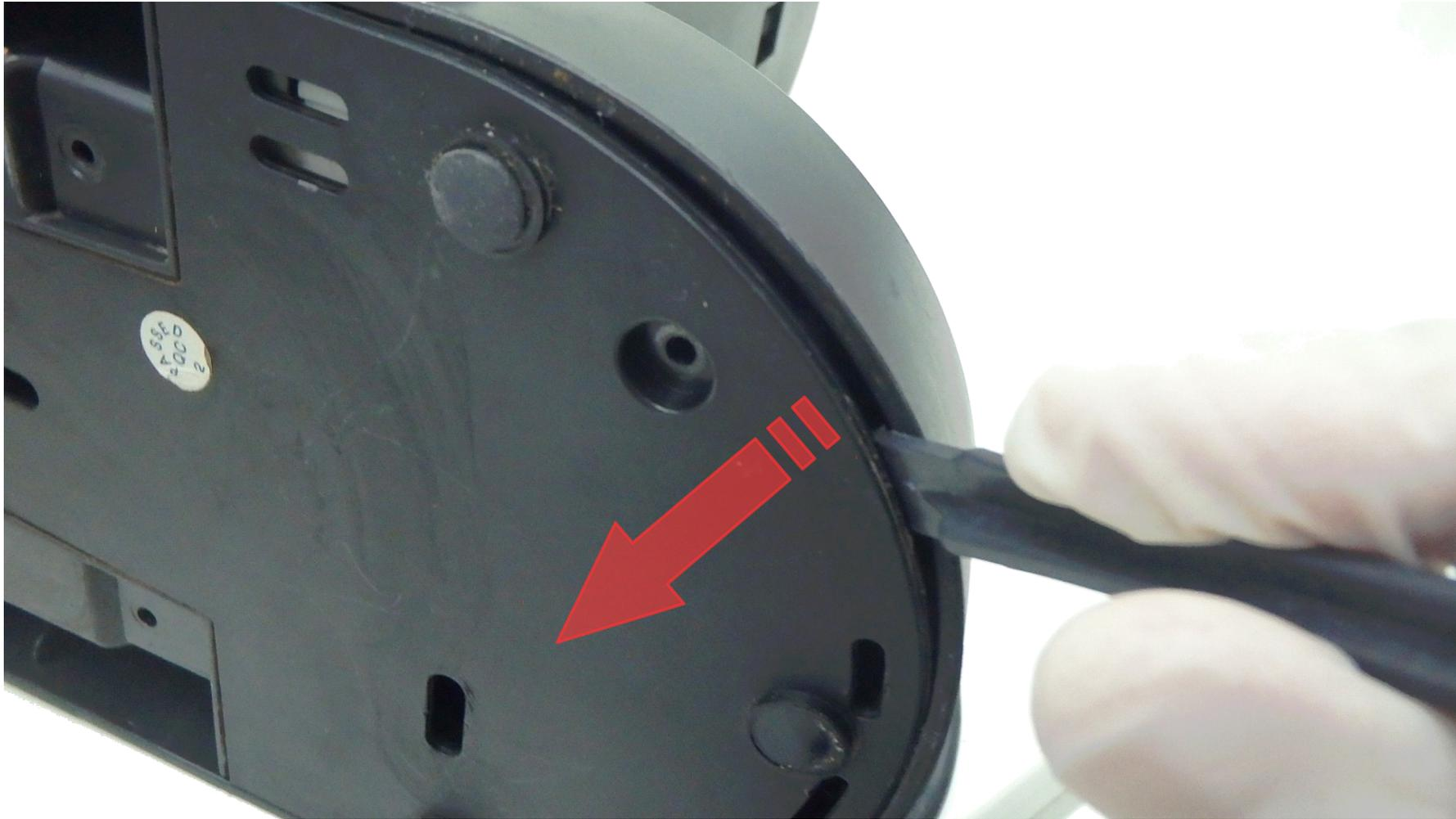
Das Gerät ist nur in die Bodenplatte gesteckt, mit etwa Kraftaufwand lässt es sich lösen. Bitte vorsichtig sein. Wir haben bei dieser schnelleren Zerlegevariante nicht die Verbindungsschläuche zum Tanksockel und nicht die Kabelverbindungen gelöst.
