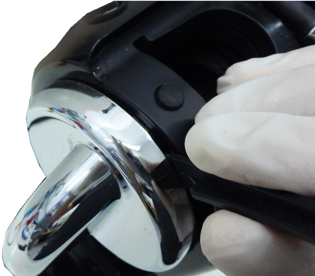
Das Gerät wieder in die Bodenplatte stecken, aufpassen, dass keine Kabel oder Schläuche gequetscht werden.
