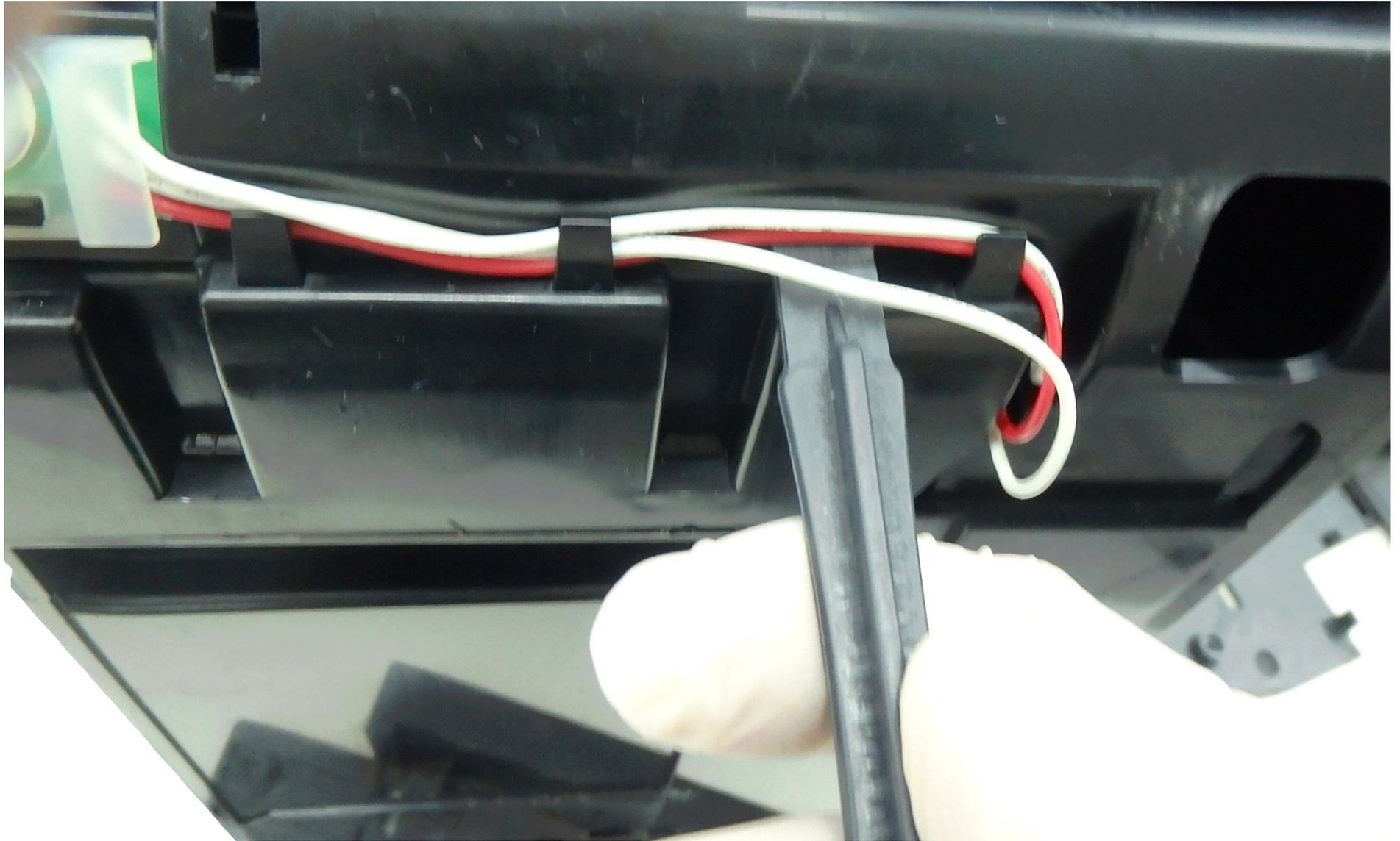
Das Oberteil kann nun abgehebelt werden. Es ist an je zwei Stellen auf jeder Seite arretiert. Mit einem breiten Schraubendreher an der ersten Stelle darunter ansetzen und abhebeln. Den Vorgang an der anderen Arretierung wiederholen.
