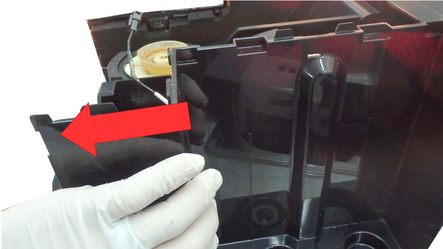
Das Kabel für den Tanksensor an der Verbindung lösen.
