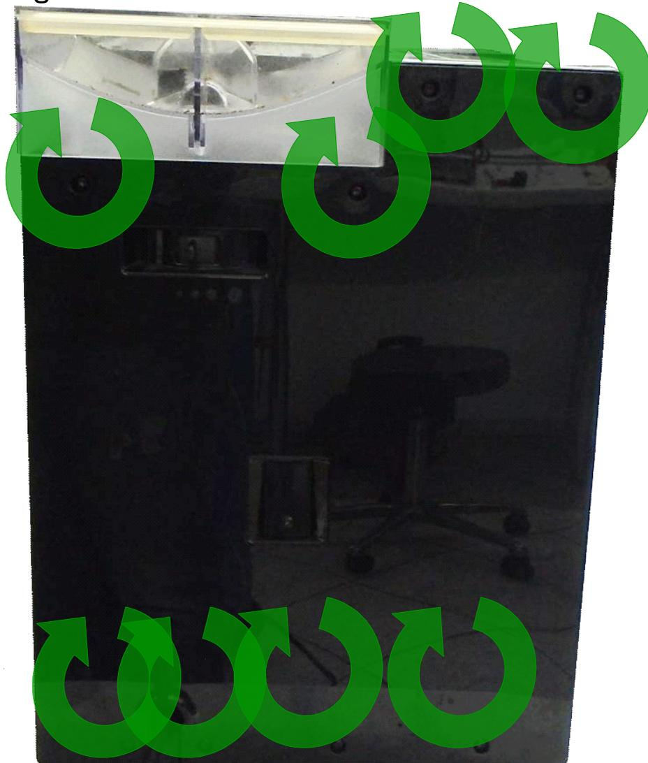
Die Tassenablage des Tassenwärmers wieder auf die Gummipuffer auflegen.
